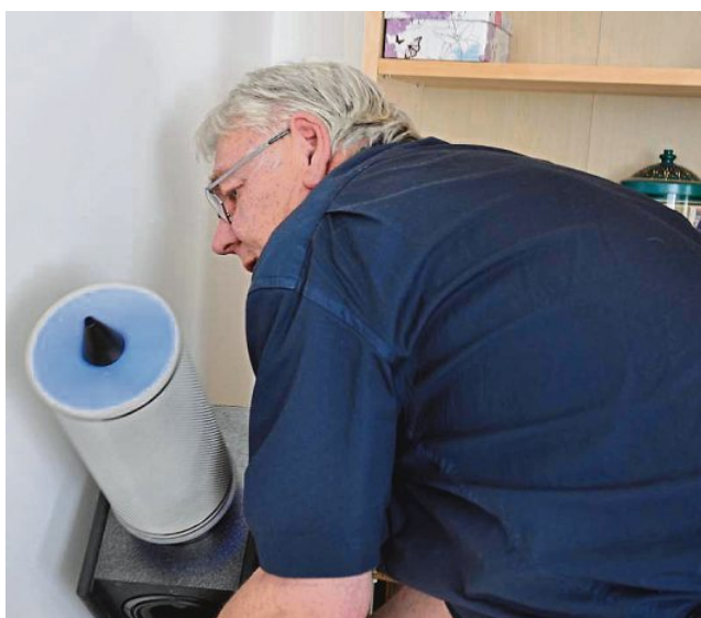
Der „Elektrostat“: Thomas Pohl (Name geändert) mit seinem elektrostatischen Lautsprecher in Zylinderform.
